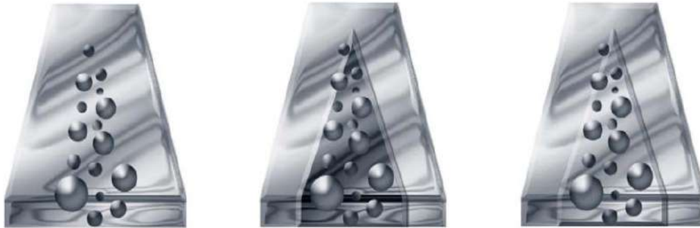
Figura No. 1 – El oxígeno forma una delgada película protectora de óxido de cromo sobre la superficie del acero.
